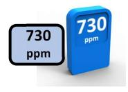
Utiliser un détecteur étalonné « en usine » et comparer les mesures des 2 détecteurs
