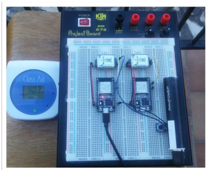
Une calibration « manuelle » du S8 est possible. Pour cela, il suffit de le placer dans un environnement où le taux de CO<sub>2</sub> est entre 400 et 430 PPM, par exemple à « l'air libre », à l'extérieur, et de suivre la procédure suivante :
