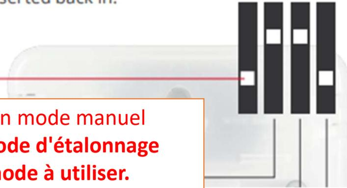
En cas de calibration automatique, l'appareil Aranet4 doit être placé en « plein air », à environ 420 ppm (par exemple, à l'extérieur ou dans une pièce avec un bon échange d'air), au moins une fois par semaine.
